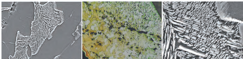
Fig. 15 izq. Microscopía electrónica de barrido con una colonia perlítica muy envejecida con una corteza de cementita
