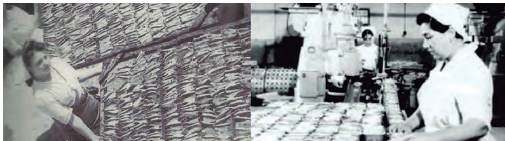
Fig. 8. Fábrica de conservas La Marplatense, cocción de sardinas en parrilla –s.f.– y fábrica de conservas La Campagnola –década de 1960–, envasado (Fuente: PENNISI, Roberto –2006– y Archivo General de la Nación, documento fílmico, Tambor 1356.C16.1.A)
